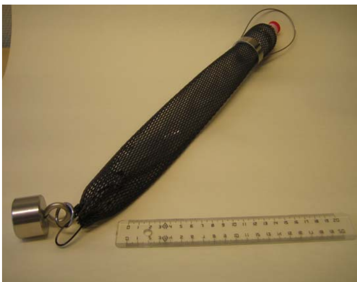
Figur 22 Passiv provtagare. Avjoniserat vatten hålls i en semi-permeabel plastpåse i strumpan (innanför det skyddande svarta plastnätet) som försluts med den röda korken. I botten fästs en tyngd för att få ner provtagaren till rätt djup och i toppen fästs ett snöre i vajerupphängningen.
