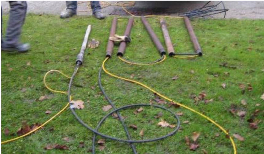
Figur 4 Slangar för bärgas respektive bentonit matas genom sonderingsstängerna innan sondering påbörjas.
