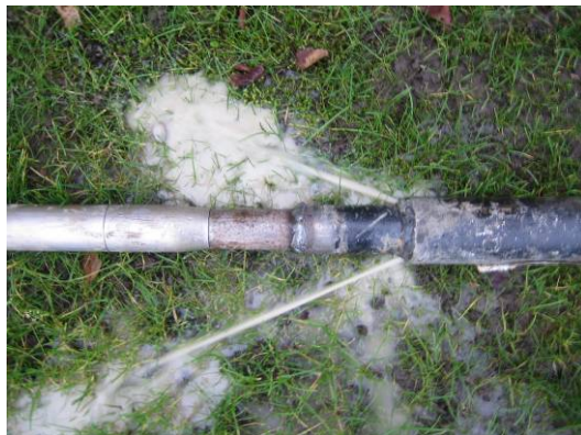
Foto 5. Munstycke från vilket bentoniten pumpas ut. Munstycket sitter monterat mellan sonden (till vänster) och sonderingsstänger (ur bild till höger). Mellan sond och munstycke är en gängadapter fastsvetsad.
