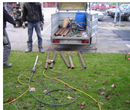
Foto 6. Hela systemet, inklusive stänger, sonden med munstycke ligger längst till vänster. Kompressor, pump och slurry förvarades på släp för lättare transport mellan punkter.
