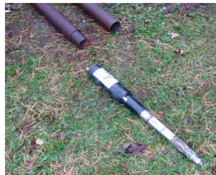
Foto 4. Underst: MIP-sond (silverfärgad) med påmonterat munstycke (gråblått). Överst: Isär monterade sonderingsstänger.
