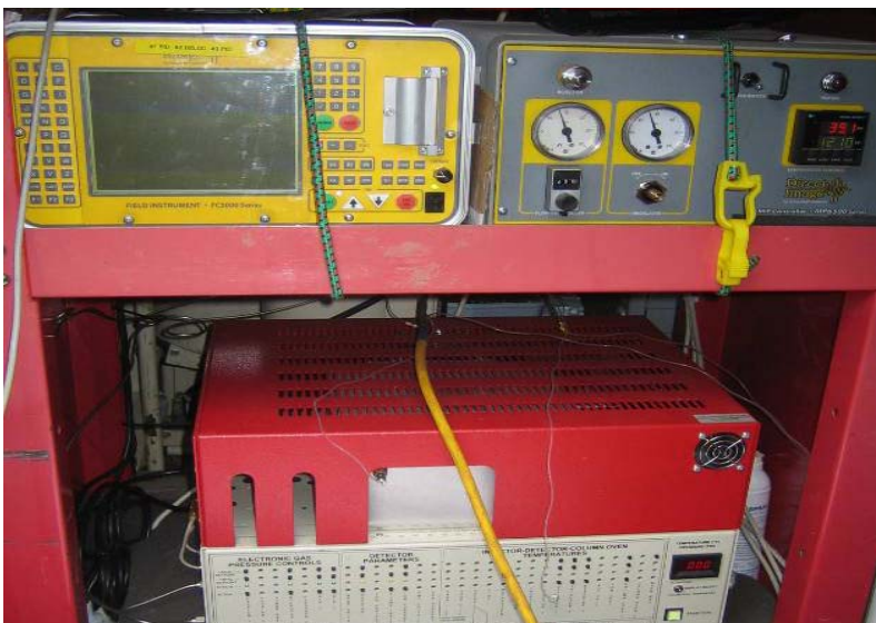
Figur 5 GC (Gaskromatograf, är "lådan" med röd kåpa, allt i undre delen av bilden) med tre detektorer (sitter tillsammans med GC-kolonnen i denna" låda"). I övre delen av bilden till vänster finns ett instrument som visar olika detektorers utslag samt till höger en tryckregulator för bärgasen. Alla mätvärden lagras i dator (ej på bilden).
