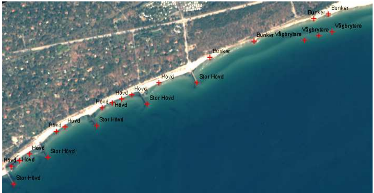
Figur 7-25. Erosionsskydd av olika typer vid Ystad strandskog. Fem stora hövder/pirar kompletteras av mindre hövder däremellan. I nordöst syns tre vågbrytare som etablerades kring år 2007.
