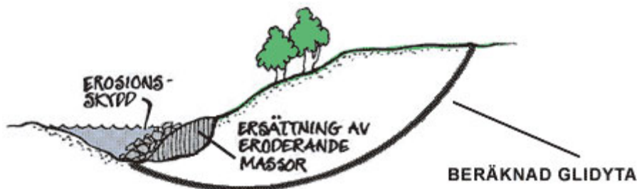
Figur 8-2. Skydd mot erosion i slänt vid vattendrag. (Skredkommissionen Rapport 5:95)
