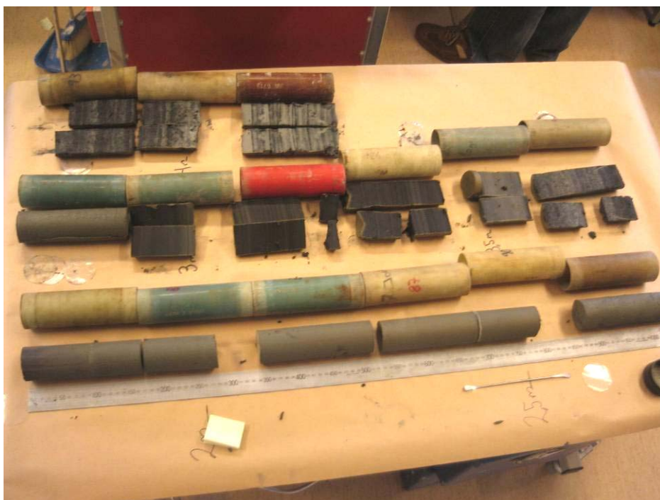
Figur 3-1. Upptagna kolvborrsprover från provområdet för fältförsöken utmed Botniabanan. Längst ned till vänster syns provkroppar tagna på 2 m djup under markytan, kontinuerlig provtagning mot djupt därefter och provet högst upp i mitten är från ca 4,3 m djup.
