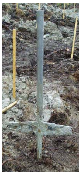
Figur 4-9. Närbild av pelarsond (500x15 mm), som användes för kontroll av pelarens hållfasthet.
