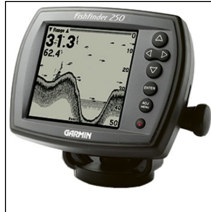
Figur 5-4. Ekolod som visar bottenprofilen. ( www.garmin.se )
