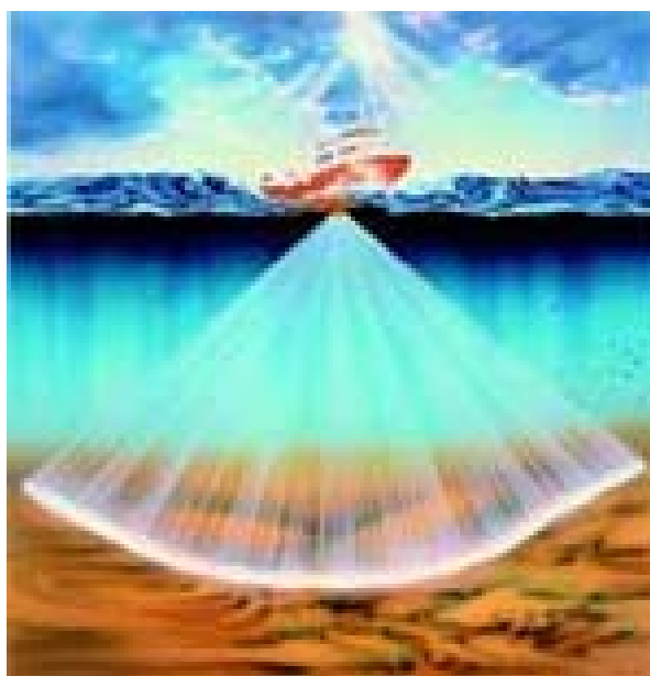
Figur 5-5. Bilden visar stålar från ett fartygs multiekolod mot bottenprofilen. ( www.kongsberg.com )
