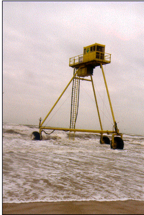
Figur 6-2. Mätutrustning av typ CRAB ( www.geog.uu.nl ).
