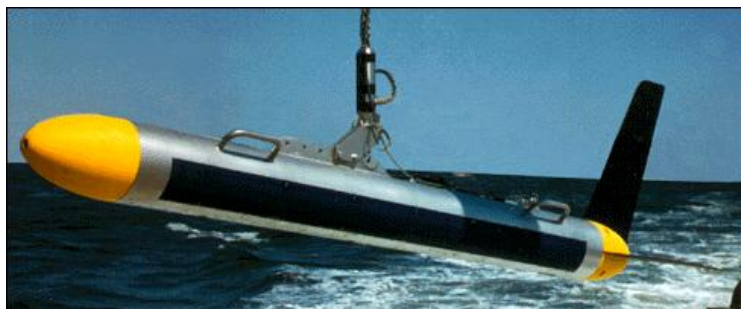
Figur 5-1. Ett bogserat mätinstrument, s.k. fisk som släpas efter ett fartyg. ( www.rsoperations.com )
