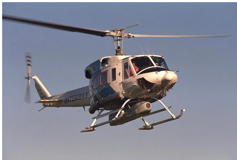
Figur 6 Utrustning för laserskanning monterad mellan landningsställen på en helikopter.
