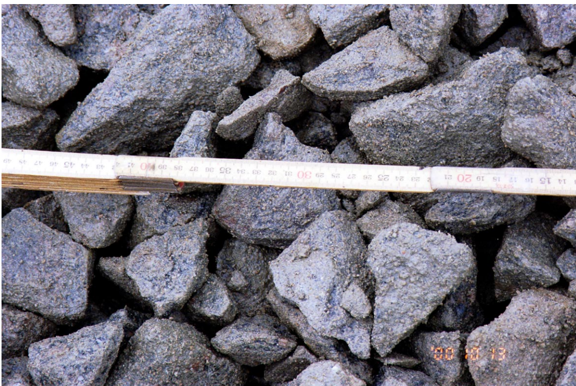
Figur 3.2-4 Detalj av fyllningsmaterial – bergkross med tumstock på Universitetsområdet.
