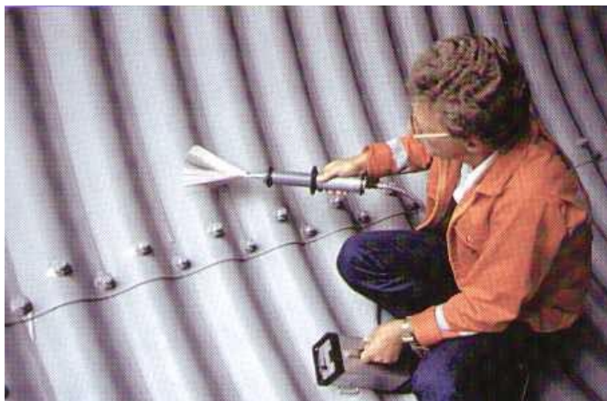
Figur 3.3-3 Porsökare av högspänningstyp vid användning på belagd plåttrumma.
