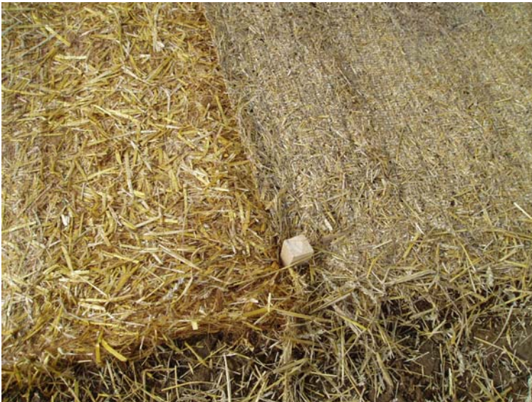
Figur 12. Halmmatta av fabrikat Greenfix, BG biomatta, typ S.
