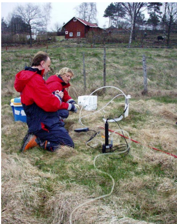
Figur 5. Provtagning med bladderpump och mätning med flödescell.
