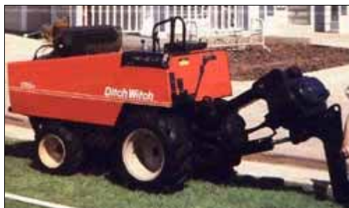
Figur 5.19. Vibrerande kabelplog främst avsedd för anläggning av serviser i trädgårdar, exempel av fabrikat Ditch-Witch 255 sx. Foto: Kjells Traktorgrävningar HB ( w1.551.telia.com/~u55102445 , 2001).
