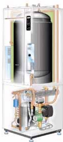
Figur 2.2. Principskiss av en modern villavärmepump inklusive vattenvärmare, elkassett, cirkulationspump samt reglerdator med display (www.nibe.se, 2000).
