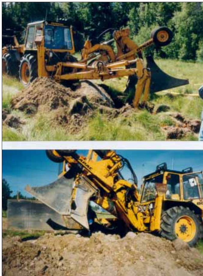
Figur 5.17-18. Vibroplog monterad på en fyrhjulsdriven traktorgrävare. Traktorgrävaren har två armar dels en vibroplog, dels ett grävaggregat. (Foto: SGI).
