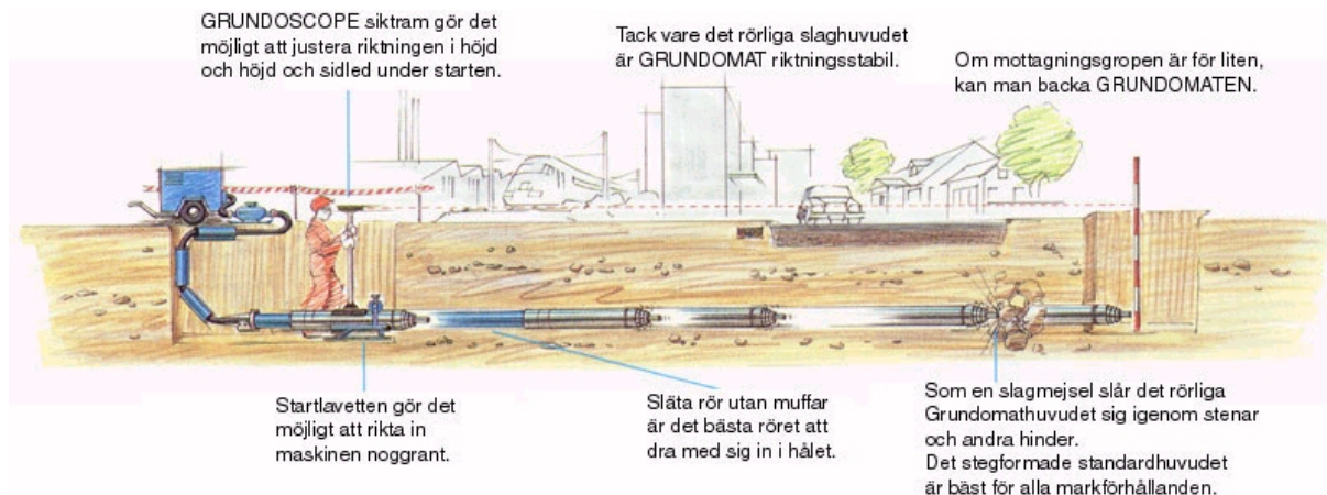
Figur 5.9. Arbetsgång vid borrhning med jordraketen. Principbild från Styrod AB ( www.styrod.se , 2000).
