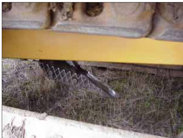
Figur 5.15. Extraplog avsedd för att underlätta plöjning vid besvärliga jordförhållanden. (Foto: Jan Fallsvik, SGI).
