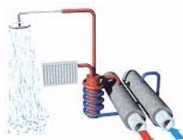
Figur 11.1. Principen för fjärrvärme ( www.tekniskaverken.se , 2001).
