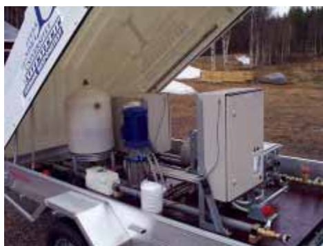
Figur 3.12. Utrustning för termisk responstest i borrhål ( www.idearc.se/respons.htm , 2001-01-25).
