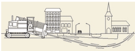
Figur 5.3. Styrdd borring ("bananborring") under diverse hinder på och i marken. Principfigur från Styrudd AB (www.styrudd.se, 2000).
