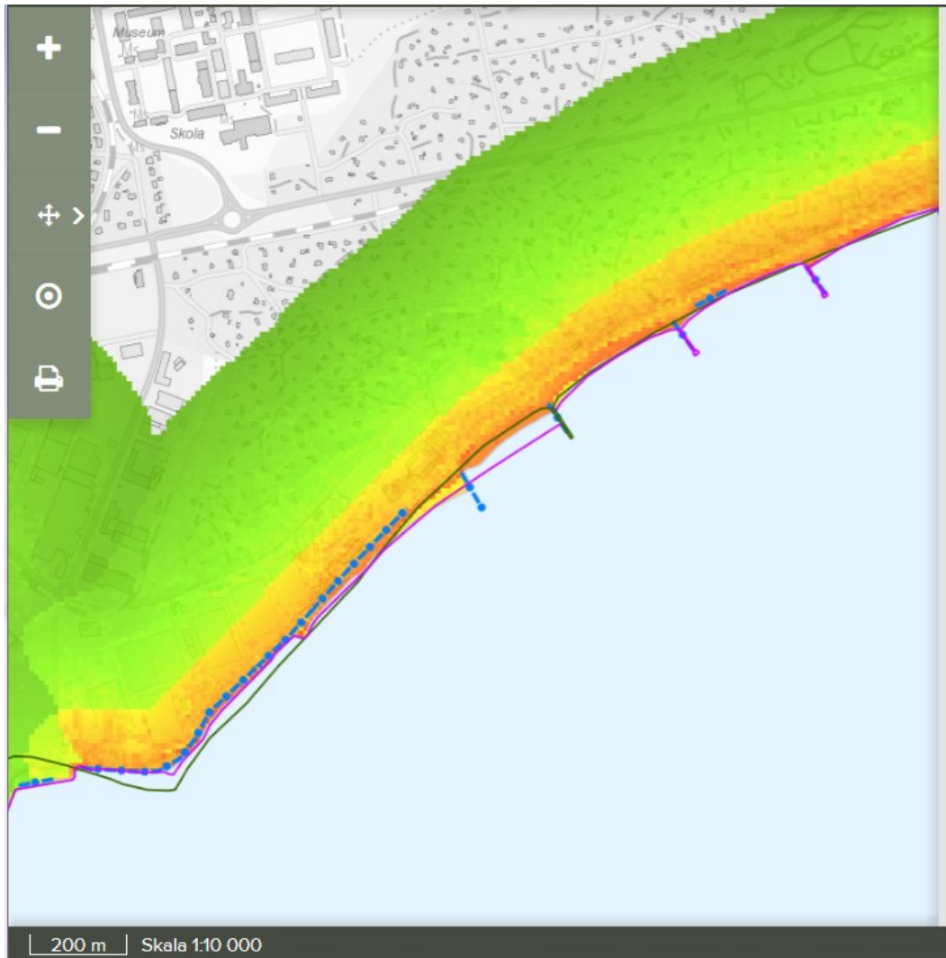
Figur 6.16 "Förutsättningar för erosion", "Historiska strandlinjer Skåne (1940, 50-, 60-, 70-tal)" och "Erosionsskydd" (blå streckande linje) i Ystad. Grön linje visar strandlinjen på 1950-talet. Den rosa linjen visar stranden på 1970-talet. Erosionsskydden har haft stor inverkan på strandens utveckling med både pålagring (ackumulation) och erosion av sand.
