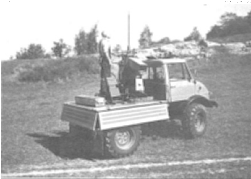
Fig. 3 Trycksond, typ SGI, monterad på en Mercedes Unimog Static penetrometer, type SGI, mounted on a Mercedes Unimog jeep
