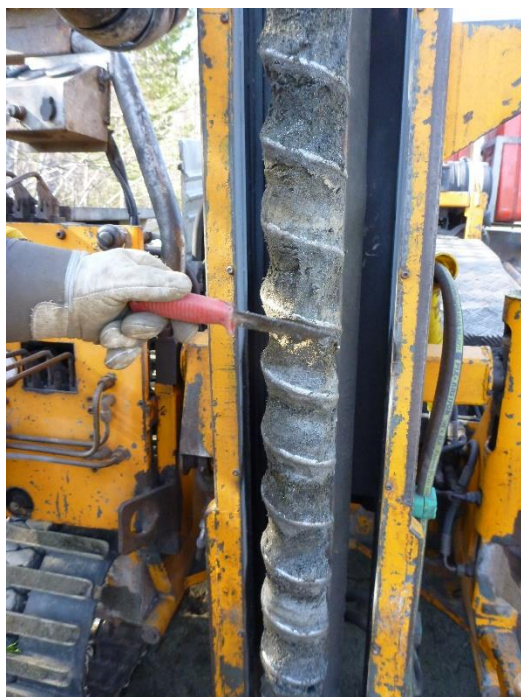
Figur 3-3. De två provtagningsstekniker som jämförs i Exempel 4: skruvborr respektive provgrop. Foto: SGI
