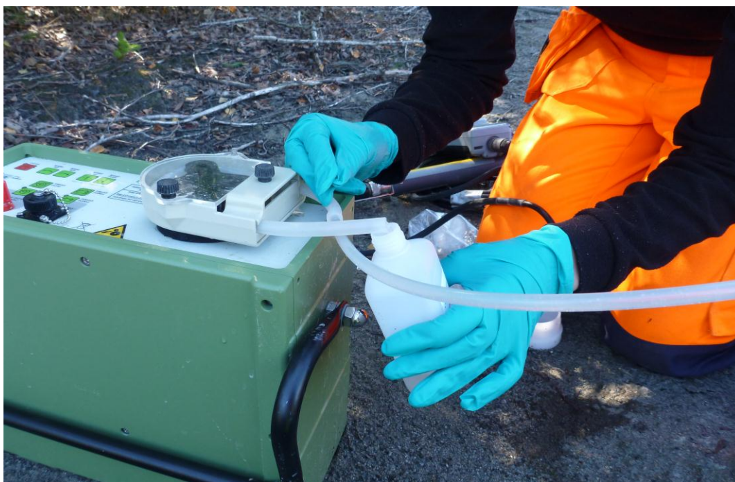
Figur 4-2 Provtagning av grundvatten. Foto: SGI.
