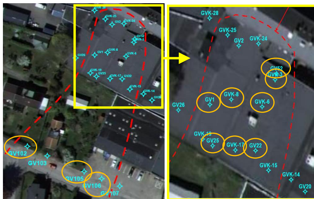
Figur 6.1 Placeringar av provpunkter/grundvattenrör, provtagna inom aktuellt projekt. Orange cirklar visar grundvattenrör i vilka tester och analyser utförts, specificerat i Tabell 6.2. Foto till höger visar källområdet (under byggnaden innanför rödstreckat). Foto till vänster även riktning avbedömd föroreningsplymen. Underliggande foto med provpunkter från WSP (2010a).
