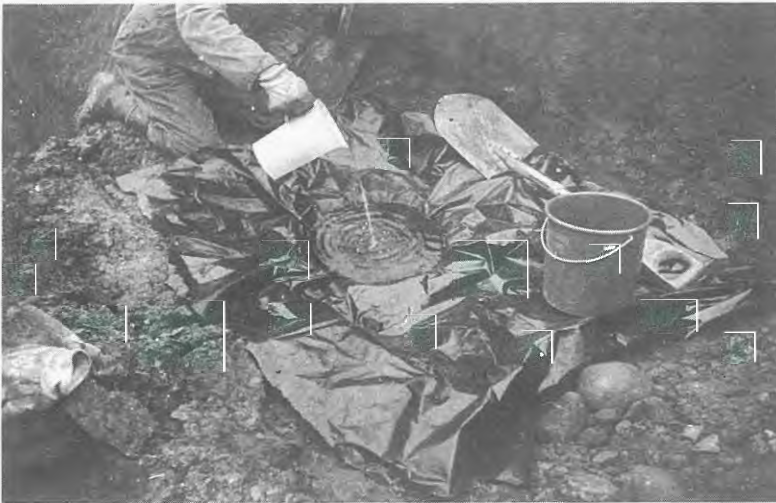
Figur 34. Provtagning med vattenvolymeter. Mätning av jordvolym.
