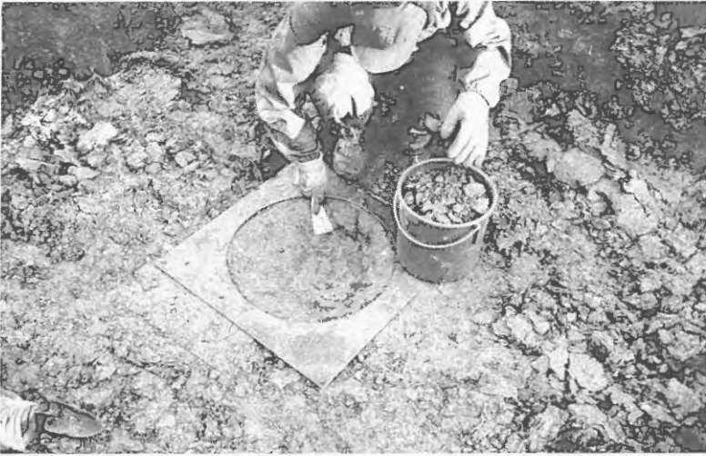
Figur 33. Provtagning med vattenvolymeter. Uppgrävning av jordprov.
