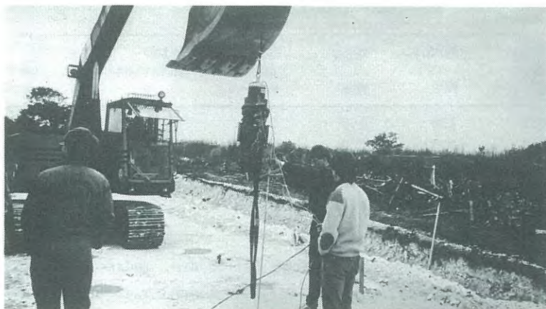
Fig. 14. Utrustning för utförande av fallviktsförsök. Fallvikt 720 kg.
