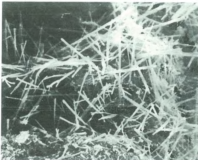
FIGUR 1. Ettringit i siltig lera stabiliserad med kalk-gips. 3000 ggr förstoring (Nieminen, 1979).
