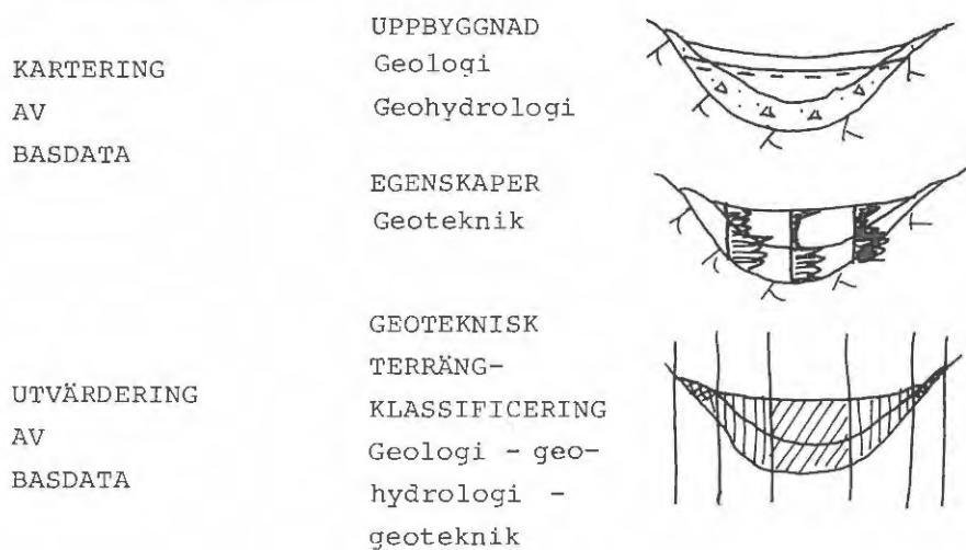
FIGUR 3. Illustration av begreppen kartering och utvärdering. Kartering av basdata ger en beskrivning av terrängens uppbyggnad och uppmätta egenskaper. Vid utvärderingen görs sammanlagring av flera basdatafaktorer för specifika ändamål - t ex geoteknisk klassificering för planering.
