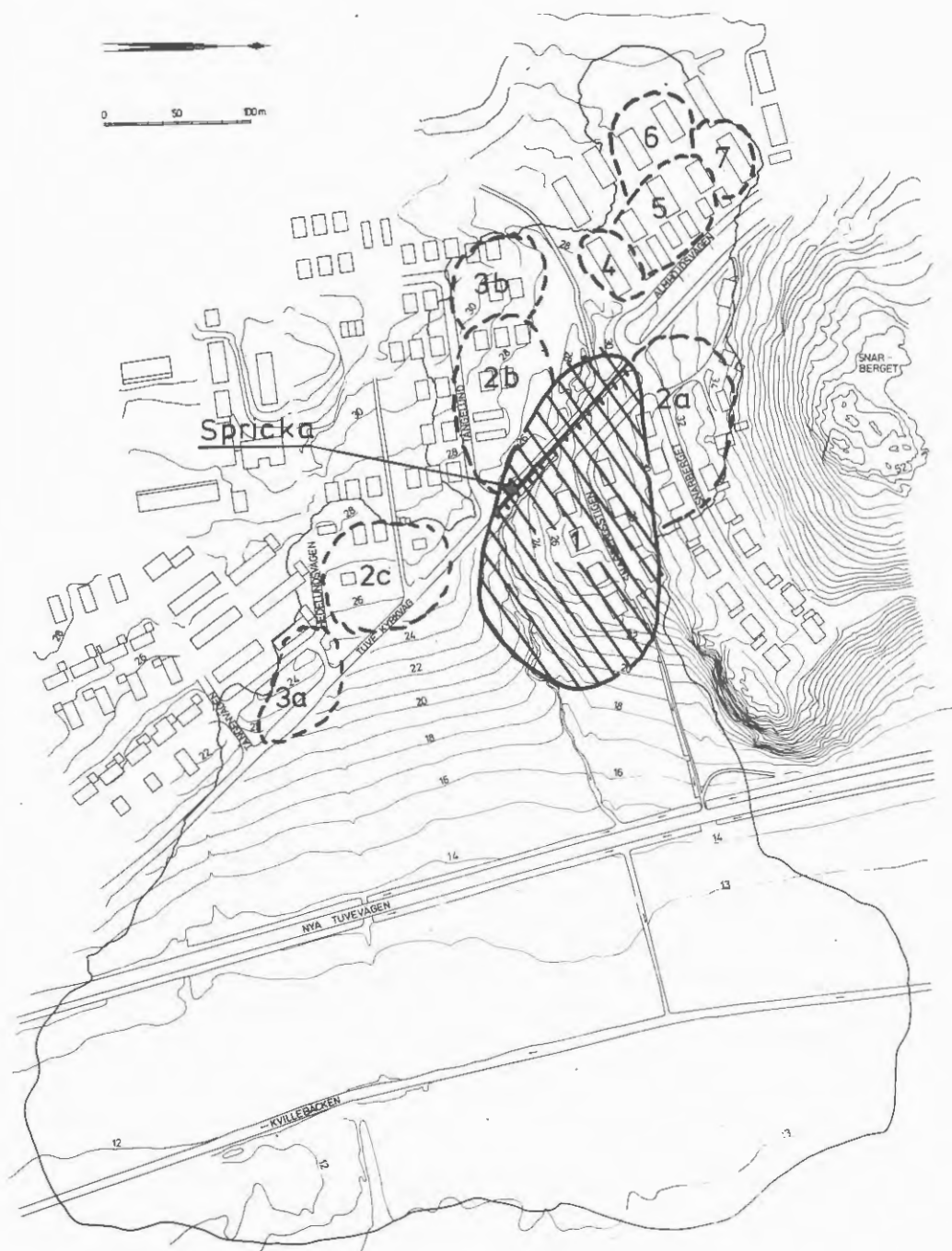
Fig. 1.4. Skredets utveckling enligt ögonvittnesskildringar. Uppgifter om förloppet i den nedre delen av skredområdet saknas. Siffrorna anger skredförloppet i den övre delen av slänten.
