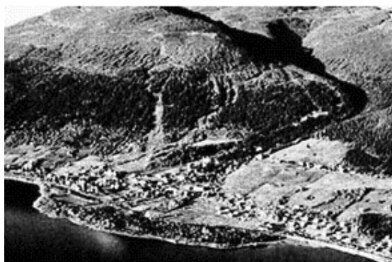
Figur 3.9 Åre samhälle ligger på avlagringar av grus och sand från ett stort antal slamströmmar som inträffat sedan istiden längs Mörviksåns ravin. Foto: J. Lundqvist, SGU 1962
