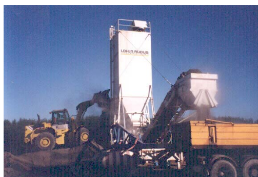
Figur 2: Tillverkning i stationär blandningsstation.
