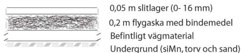
Figur 12: Principsektion grusväg Luopioinen, (se även Bilaga I-5).
