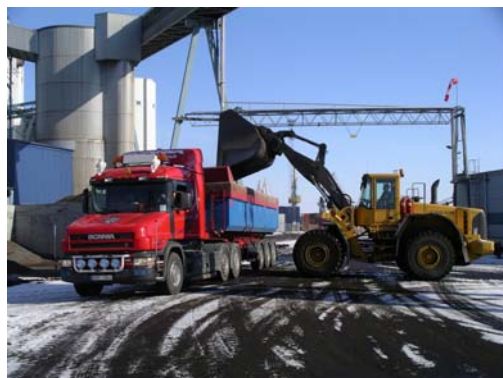
Figur 6b: Trailer lastbil med 30 tons kapacitet.
