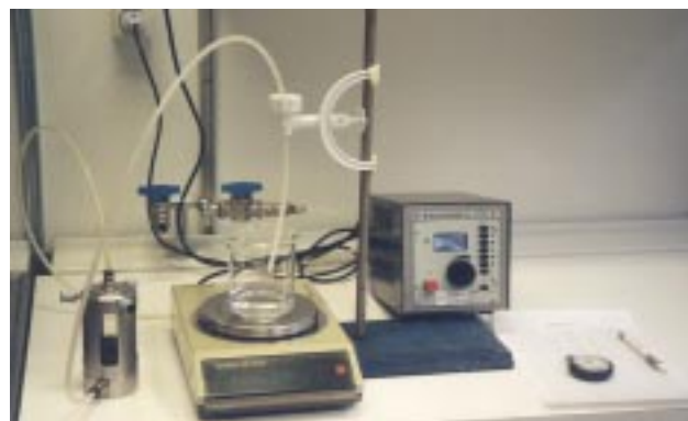
Fig. 5.3 Övertryckskapillarimeter med tryckregleringsutrustning och våg för mätning av utpressad vattenmängd.
