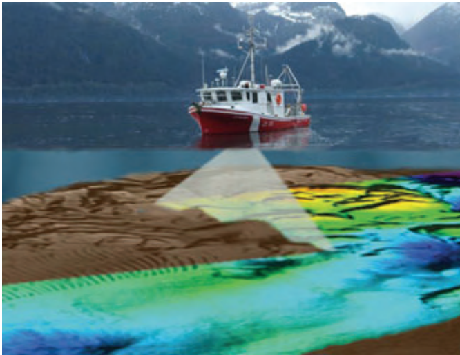
Figur 6-5. Principen för multibeamekolodning: ljudpulser från ett fartyg reflekteras mot botten och en 3D-modell skapas (www.charts.gc.ca, november 2011)
