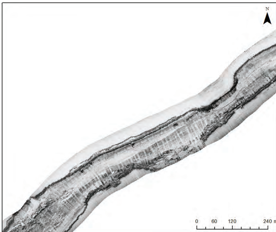
Figur 6-7. Bottenförhållanden undersökta vid Åkerström med sidescan sonar (arbetsmaterial, Klingberg et al., 2006).
