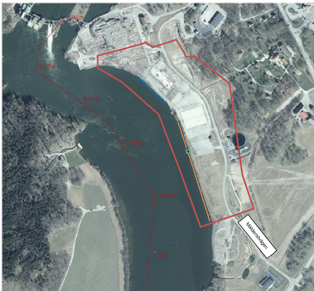
Figur 1 Översikt avgränsning av utredningsområdet (röd linje), befintlig betongkaj från början av 1980-talet cirka 125 m lång (blå linje), befintligt erosionskydd utlagt år 2010 (orangea linjer) samt stålspont (grön linje).
