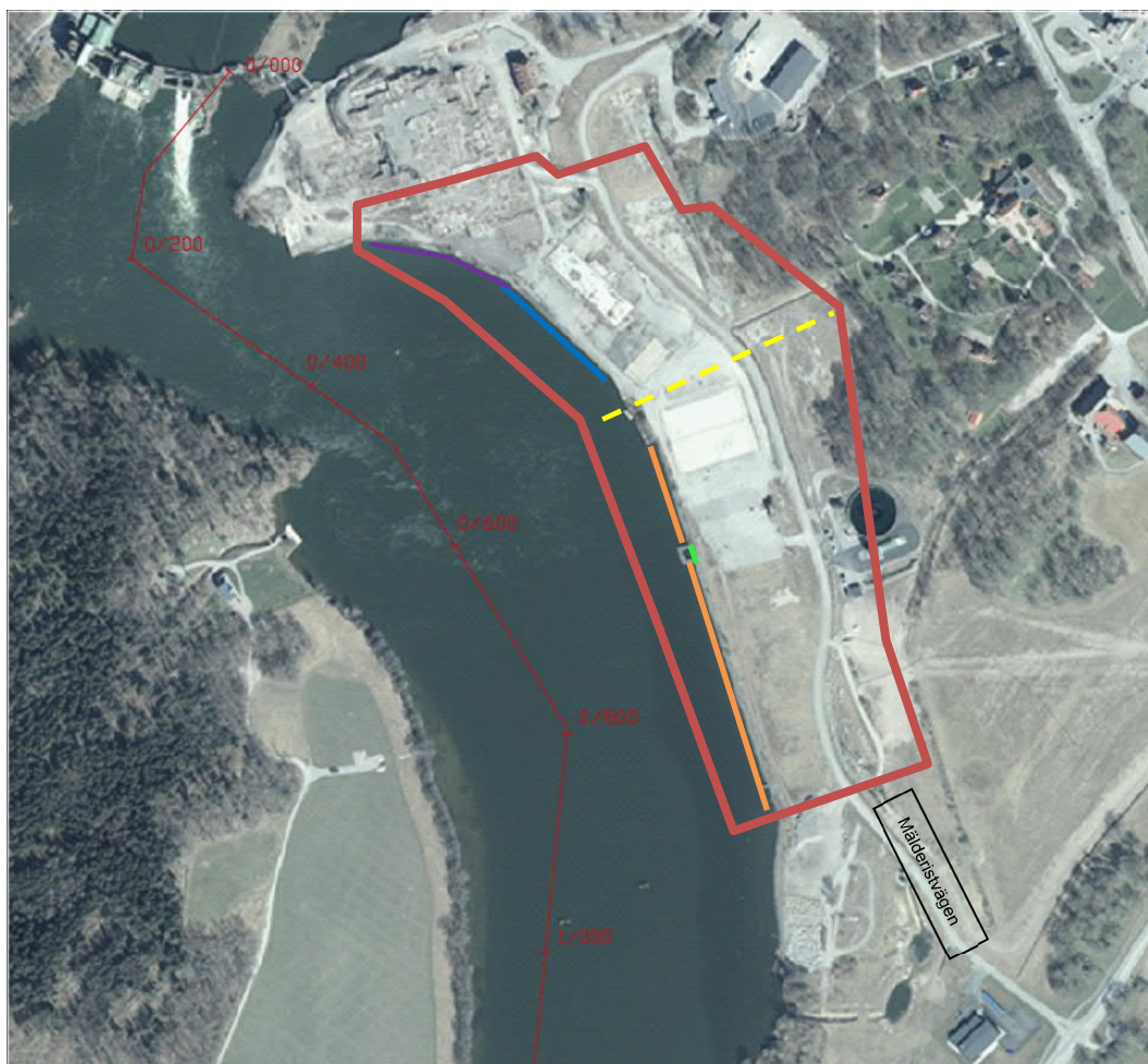
Figur 1 Översikt i plan. Avgränsning av utredningsområdet (röd linje), stålspont (lila linje), befintlig betongkaj från början av 1980-talet (blå linje), befintligt erosionsskydd utlagt år 2010 (orangea linjer), stålspont (grön linje). Delområdesgräns mellan det norra och södra utredningsområdet (gul streckad linje). (Flygfoto: Lantmäteriet).
