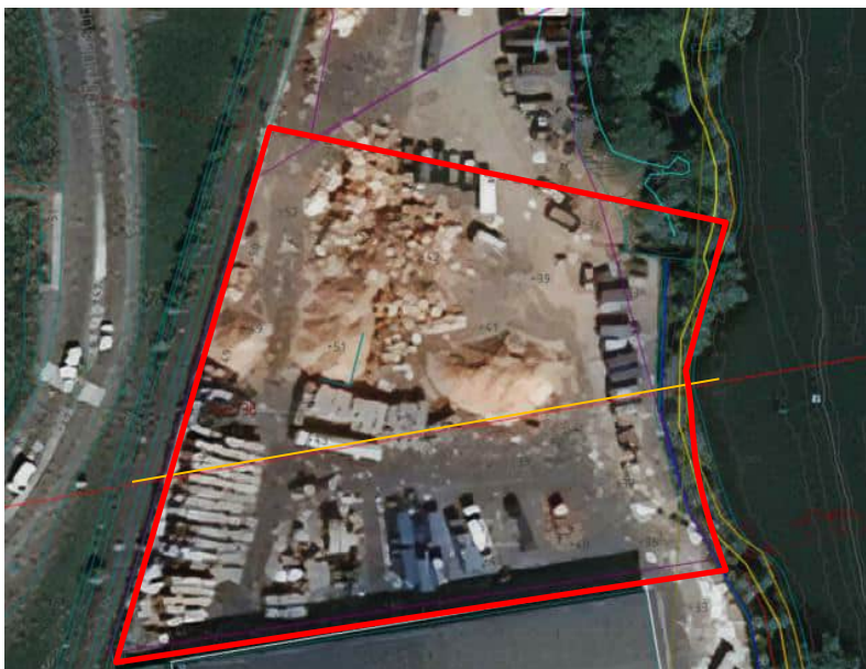
Figur 7-5 Beräkningssektion Bs läge markerat med orange. Ungefärlig omfattning av området som representeras av sektionen markerat med rött.
