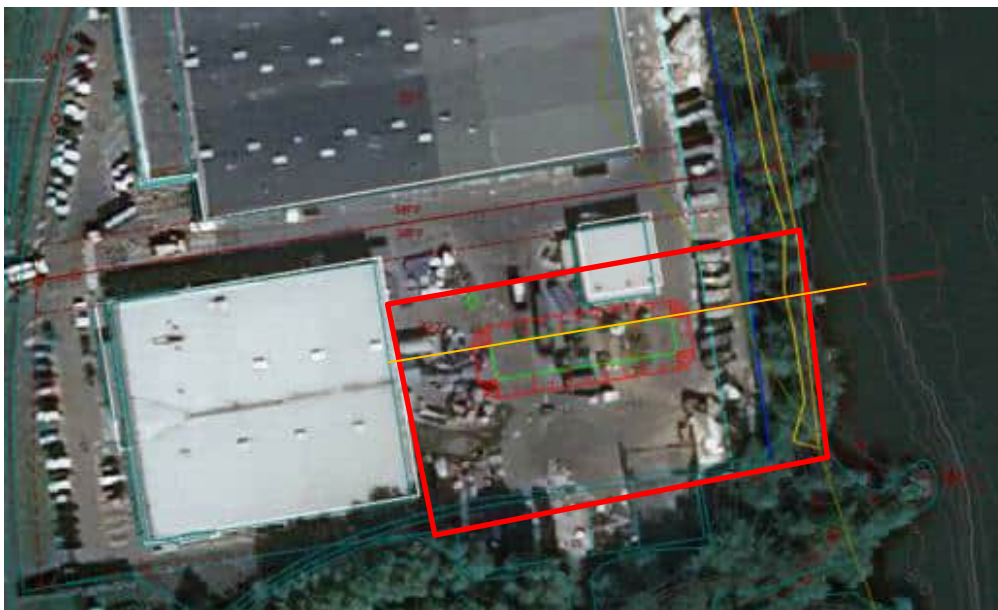
Figur 7-14 Beräkningssektion Es läge markerat med orange. Ungefärlig omfattning av området som representeras av sektionen markerat med rött. Läge för tänkt dagvattenmagasin syns i linje med beräkningssektionen.
