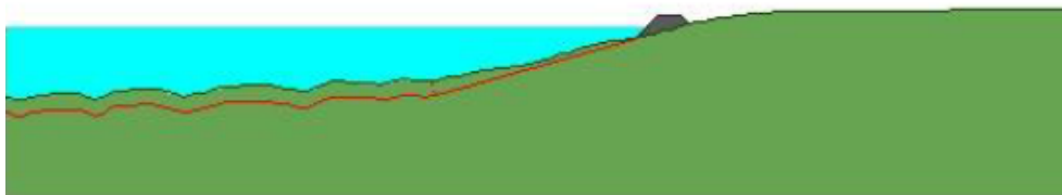
Figur 23. Typsektion för slänt utan undervattenshylla och med erosionsskydd i vattenbrynet.
