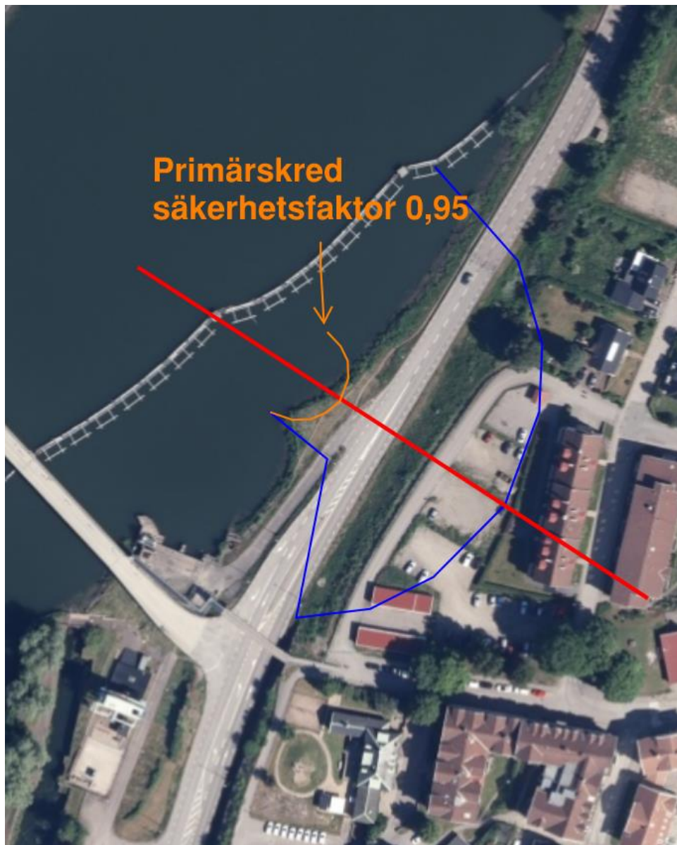
Figur 31. Uppskattad utbredning i plan av eventuella primärskred (orange) och sekundärskred (blått) för skred i sektion km 31/5150. (Kartkälla: minkarta.lantmateriet.se 2023).
